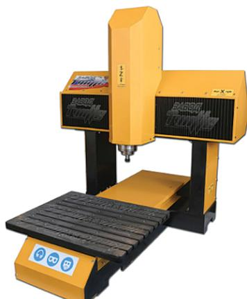
Рис. 1. Общий вид трёх-осевого фрезерного станка с числовым программным управлением.
